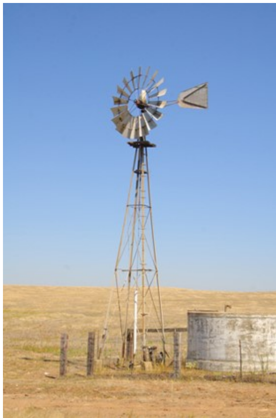
Abbildung 3. Windmühle zum Pumpen von Wasser [2.15]
